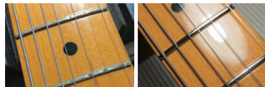
フレット交換のピフォー（左）、アフター（右）。格段に、弾き心地や音色が変わってくる。
